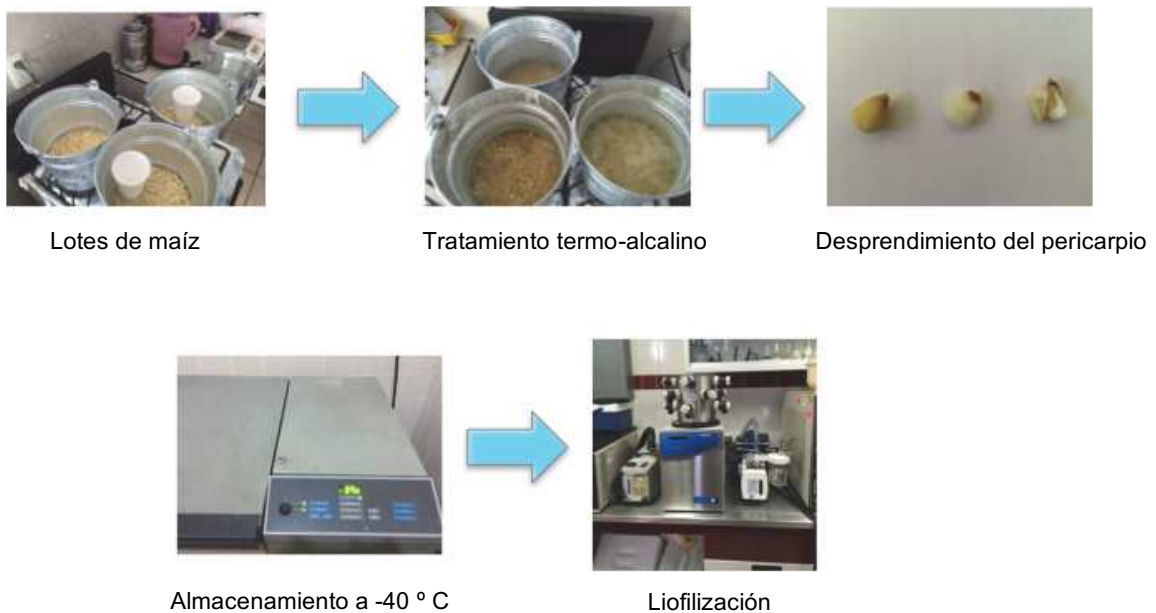
Figura 4. 1 Pre tratamiento de la muestra para determinar el contenido de micotoxinas durante la nixtamalización
