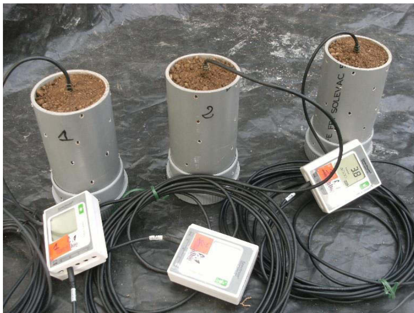
Photo 3 : Etalonnage des sondes réflectométriques avant leur mise en pot
