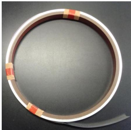
Figure II- 1 : Alliage 2024 ALUDIS, tôle laminée d'épaisseur 30  $\mu\text{m}$
