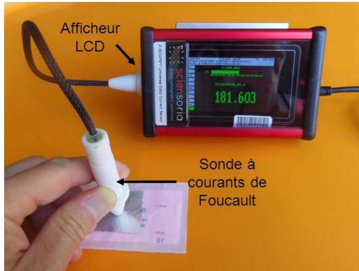
• **Figure II- 13 : Photo de l'afficheur LCD et de la sonde à courants de Foucault**
