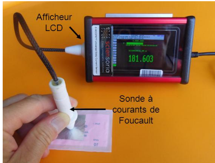
• Figure II- 13 : Photo de l’afficheur LCD et de la sonde à courants de Foucault
