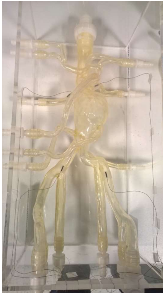
Figure 4.2 - Fantôme physique (modèle en silicone) représentant la structure vasculaire d'intérêt et quatre capteurs de test fixés sur le fantôme.
