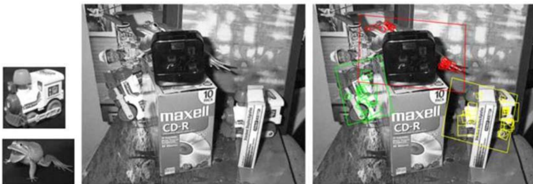
Figure 5.11 – Détection de points d'intérêt locaux par méthode SIFT [195].
