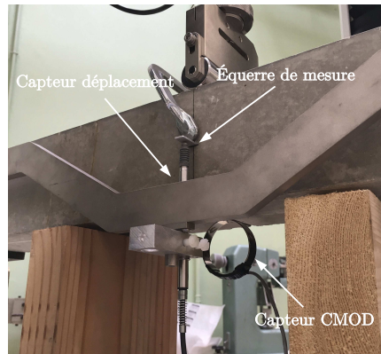
FIGURE 4.1.9 – Dispositif de mesure de flèche et d'ouverture de fissure
