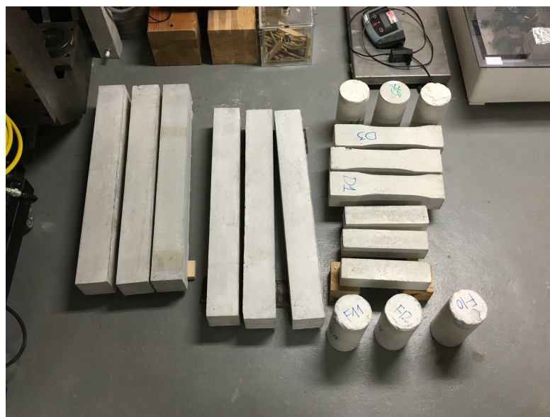
FIGURE 2.2.5 – Stockage sur tasseaux de bois en salle régulée en hygrométrie et température
