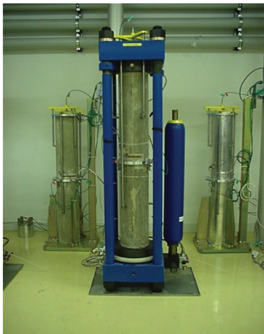
FIGURE 3.2.3 – Dispositif de mesure de fluage
