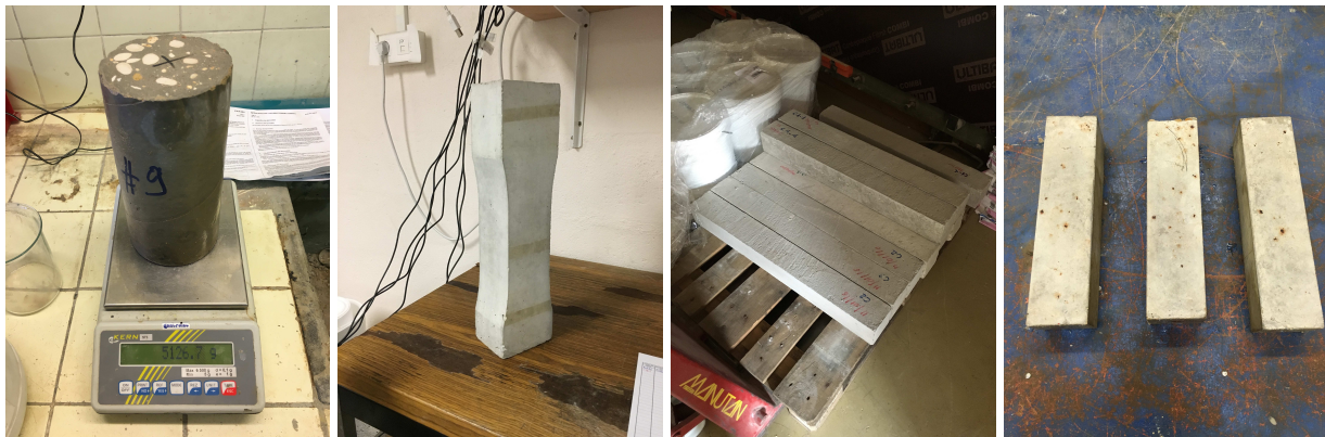
(a) G1 : cylindre 11 cm × 22 cm (b) G2 : dogbone 35 cm × 10 cm (c) G3 : parallélépipède 10 cm × 10 cm × 84 cm (d) G5 : parallélépipède 7 cm × 7 cm × 28 cm
