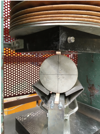
FIGURE 1.1.3 – Essai brésilien à la presse
