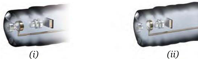
Figure 2.1.1 – Système optique à focale double embarqué dans la nouvelle gamme de coloscopes Olympus® Evis Lucera Elite (extrait de la brochure). (i) Système dans son mode de fonctionnement dit "normal" utilisé pour l'exploration du côlon (image mise au point dans une plage de distance d'environ 2 mm à 10 cm). (ii) Seconde configuration du système optique permettant l'observation détaillée de la lésion (à une faible distance de l'extrémité distale du coloscope).
