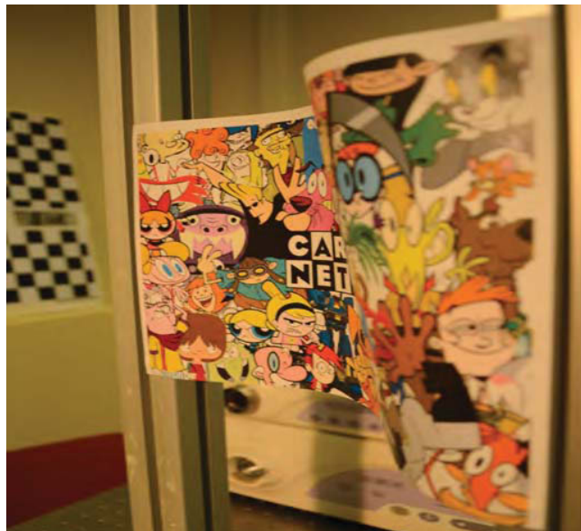
Figure 1.2.2 – Illustration de la relation liant le degré de mise au point d’un objet à sa profondeur d’acquisition. La quantité de flou optique augmente en fonction de la distance d’un point de la surface à la profondeur de champ (plage de distance pour laquelle un objet apparaît visuellement nette).
