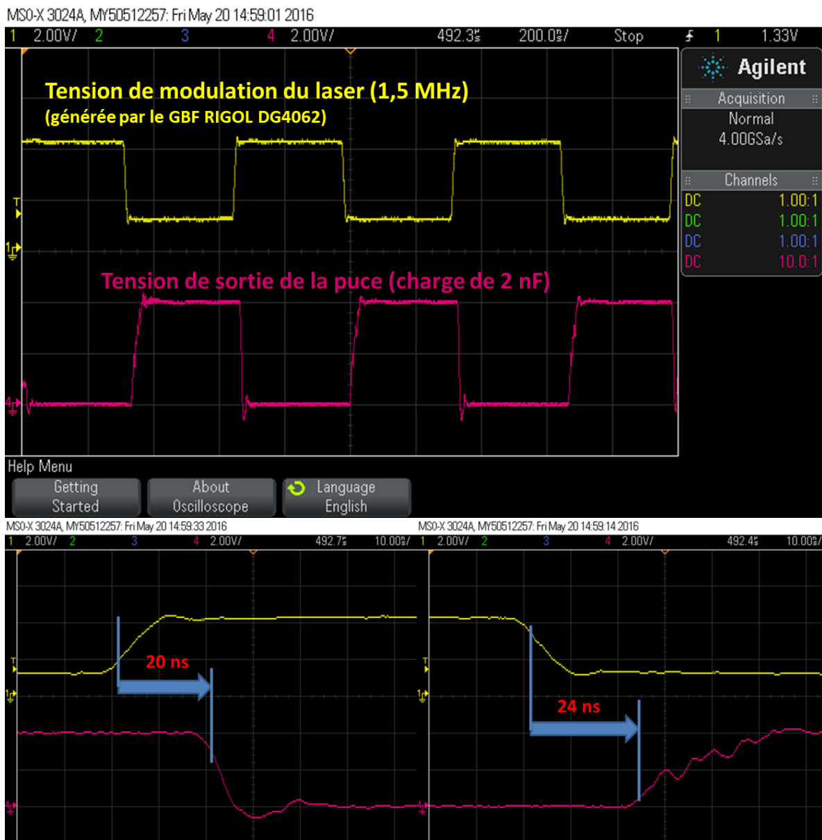
Figure 3-14 : Test du circuit de réception en bande de base. Modulation à 1.5 MHz sur une charge de 2 nF.
