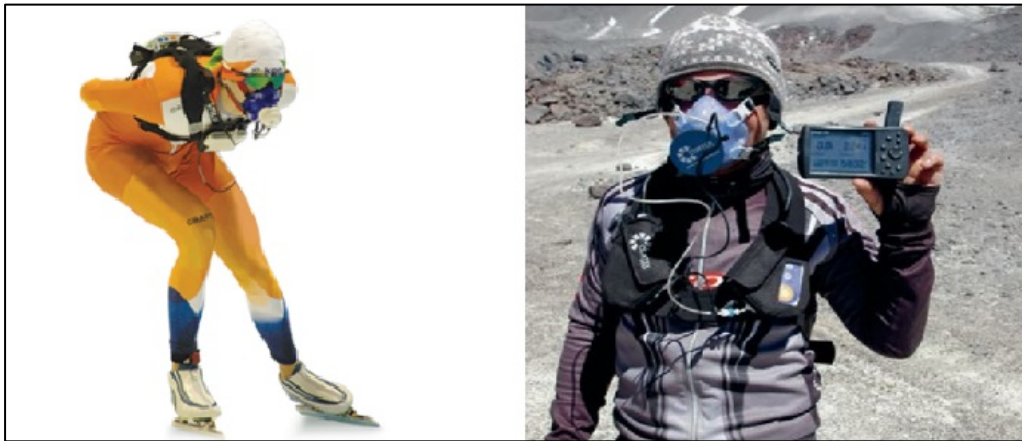
Figure 8 : Méthode de la calorimétrie indirecte à partir d'un analyseur des échanges gazeux portable. À gauche, le K4b 2 (Cosmed) et à droite, le MetaMax (Cortex Biophysik GmbH)
