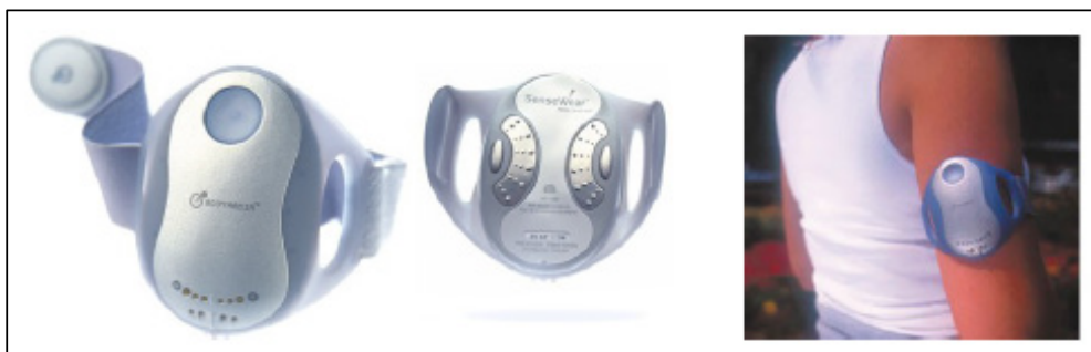
Figure 17 : Le SenseWear Armband ® et son placement au niveau du bras du sujet
