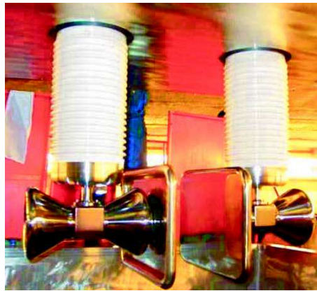
FIGURE 3.4 – Photo des plaques du déflecteur électrostatique de SHELS (Dubna) [57] : une grande différence de potentiel entre celles-ci permet de créer le champ électrique dont on a besoin pour effectuer la sélection / Photography of the electrostatic deflector plates of the SHELS separator in Dubna [57] : a strong potential difference between them creates the electric field needed for the selection
