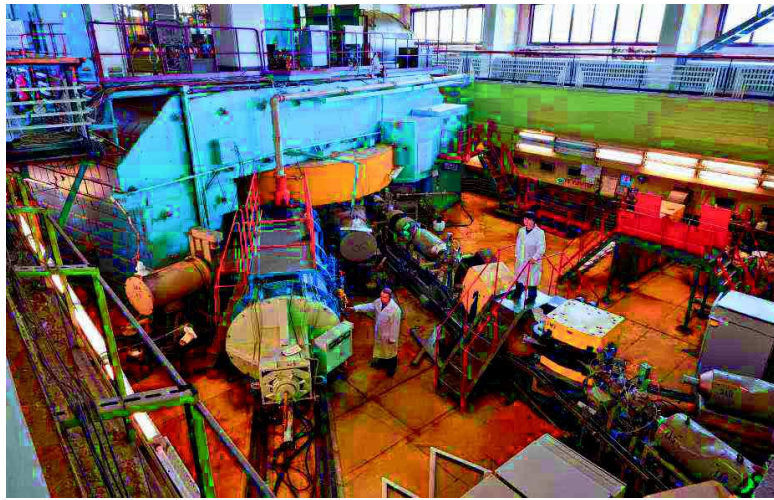
FIGURE 4.1 – Cyclotron U400 du JINR à Dubna (en bleu) avec au-dessus le système de source d'ions lourds (ECR) et d'injection axiale [98] / U400 Cyclotron at JINR in Dubna (blue), and on the top the heavy ion source (ECR) with the axial injection system into the cyclotron [98]
