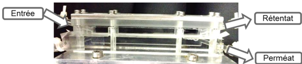
Figure 2. 12 : photo de la cellule de filtration pour l'expérience de micro-PIV
