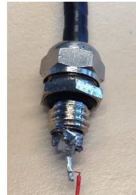
Figure 3.14 – Vis de connexion d'un câble coaxial
