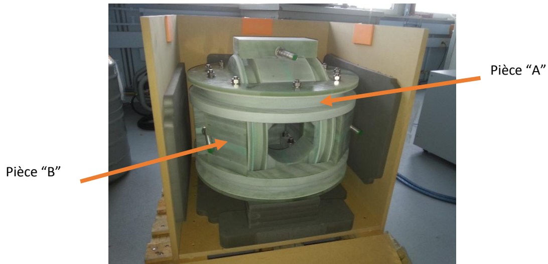
Figure III-32. Supports de l'aimant vectoriel en G11, arrivés au laboratoire.
