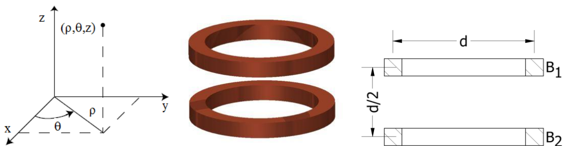
Figure III-2. Schéma de la Bobine de Helmholtz.
