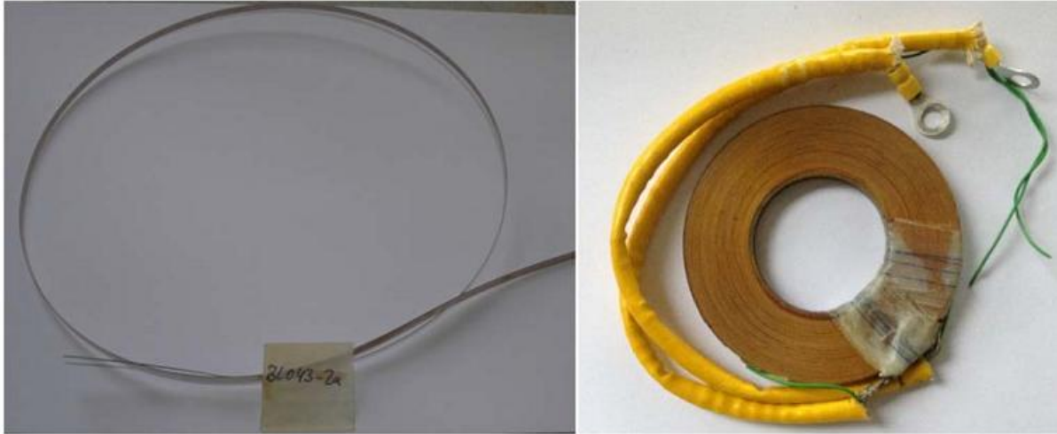
Figure II-2. Echantillon du ruban BSCCO 2212 et la bobine supraconductrice utilisé dans l'essai.
