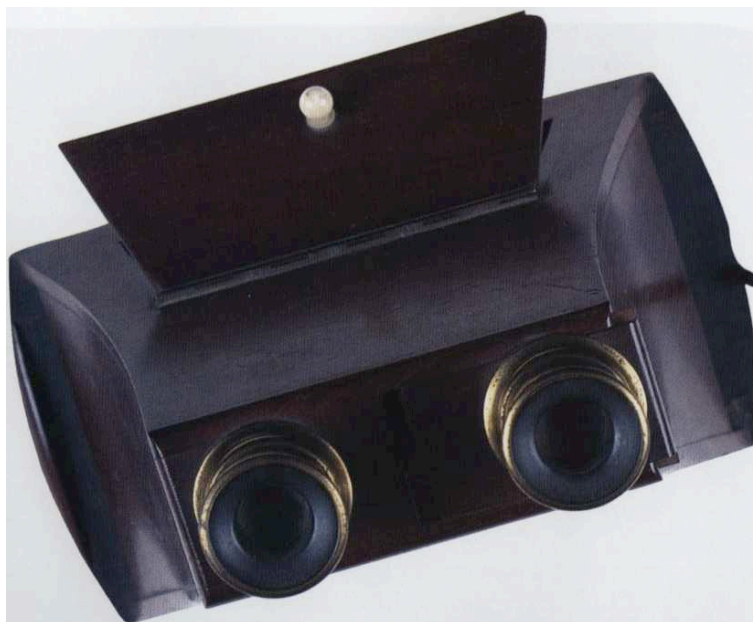
Fig. 16. Reproduction du stéréoscope lenticulaire de David Brewster, construit par Jules Duboscq 137
