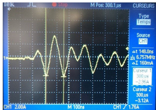
Figure 4-51 Perturbation électromagnétique à la commutation
