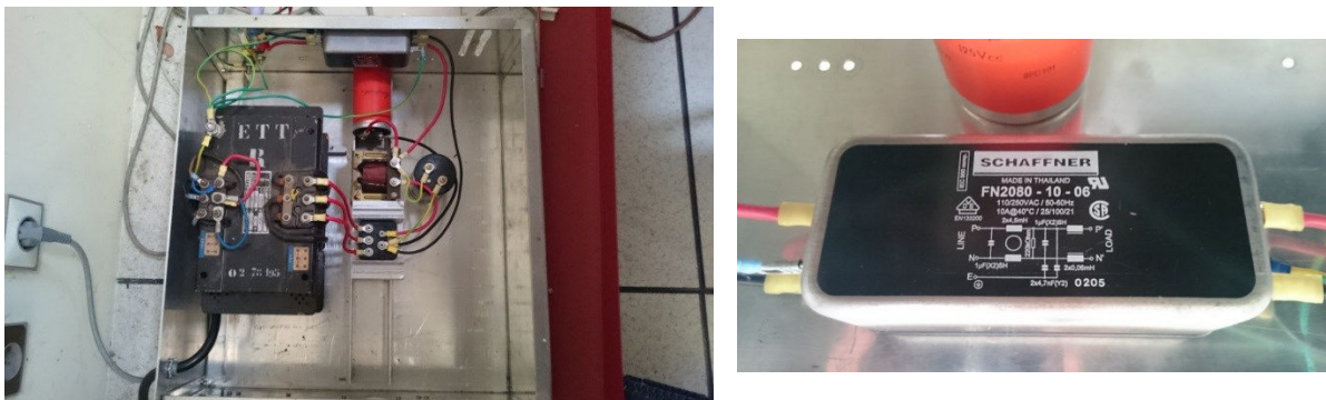
Figure 4-49 Détails de la source DC protégée
