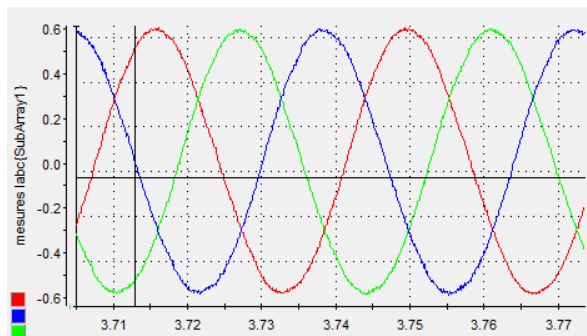
Figure 4-65 Courant de phase moteur abc lors de la phase basse vitesse de la MSAP
