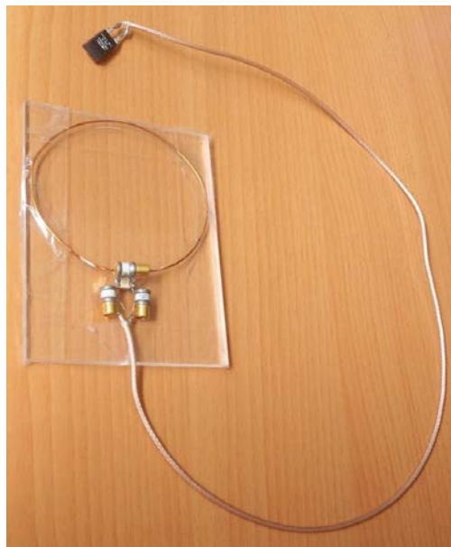
FIGURE 3.1 - Antenne de surface simple fabriquée au laboratoire IADI.
