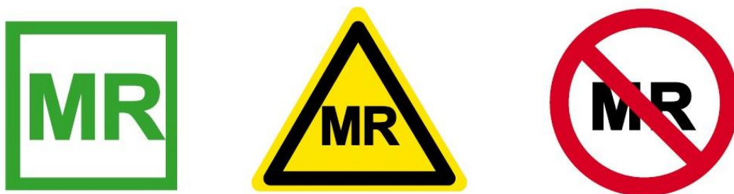
FIGURE 2.1 : De gauche à droite : Label « MR Safe », label « MR Conditional », label « MR Unsafe ».
