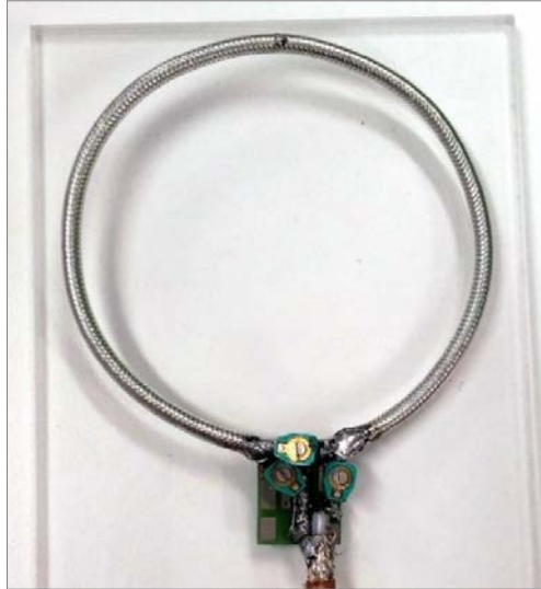
FIGURE 2.3 - Antenne boucle avec circuit de tuning et matching fixée sur son support.
