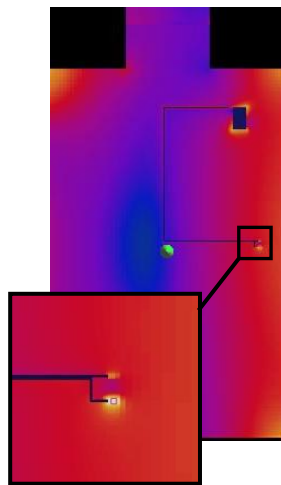
FIGURE 2.17 - Carte de SAR dans le fantôme ASTM en simulation, le pacemaker avec sa sonde connectée et la sonde abandonnée étant en position anatomique. Les extrémités des deux sondes sont espacées de 5 mm.
