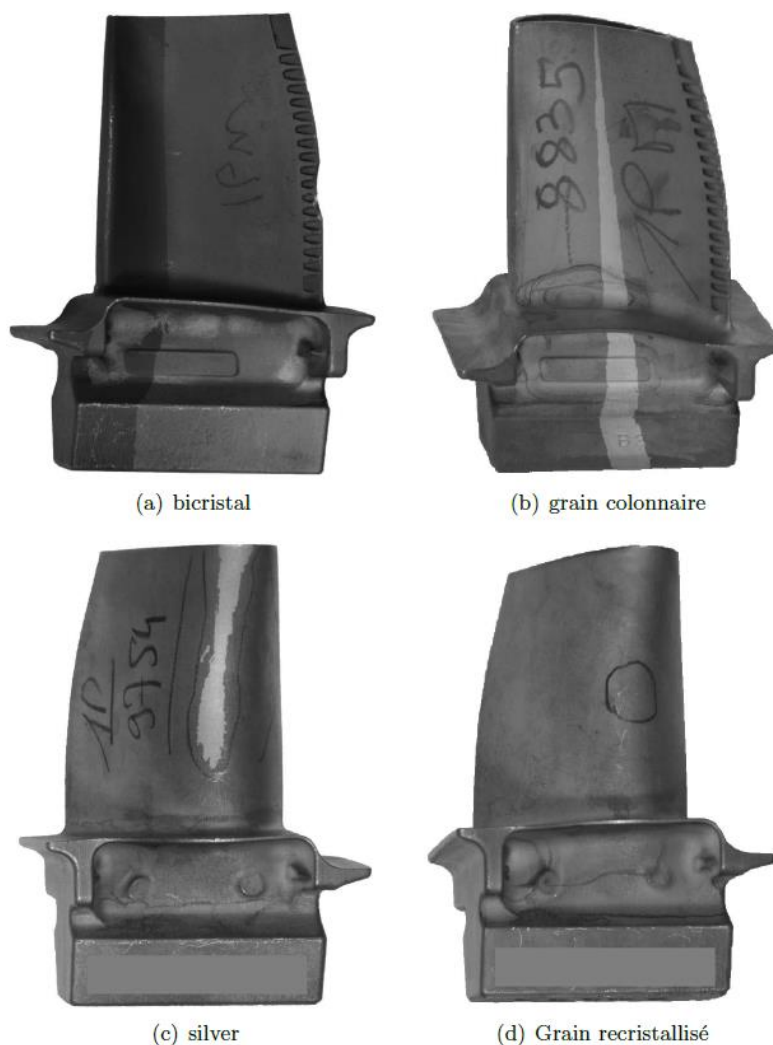
Figure 22 – Défauts de fonderie de type grain parasite [43]
