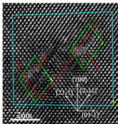
Figure 33 – Cliché MET Haute Résolution des superpartielles qui composent une dislocation a[100] dans la direction [011] [76]
