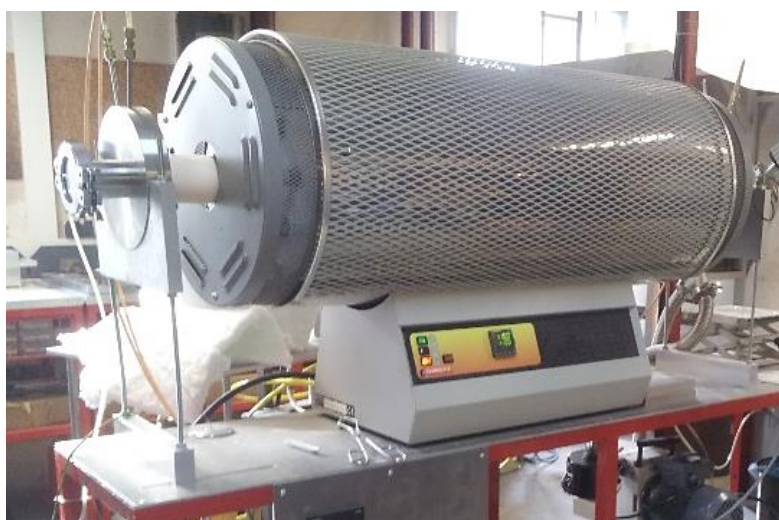
Figure 70 – Four tubulaire utilisé
