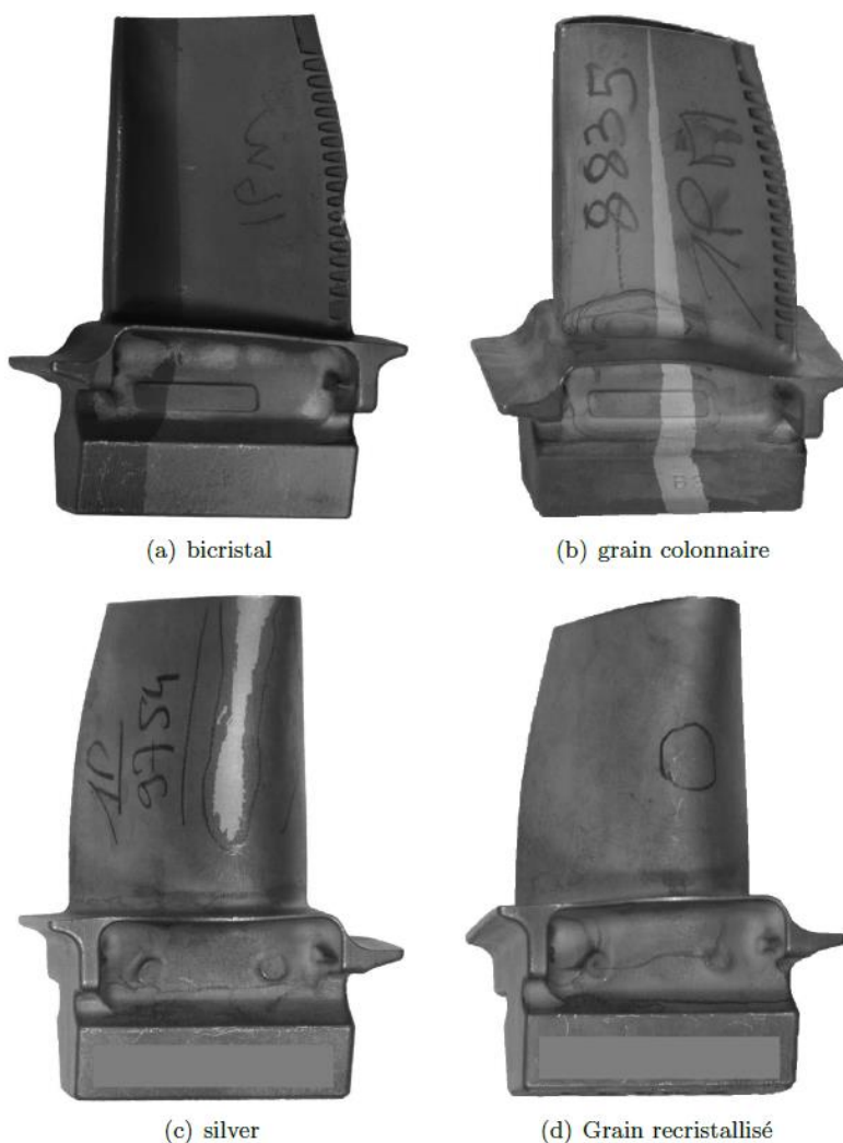
Figure 22 – Défauts de fonderie de type grain parasite [43]
