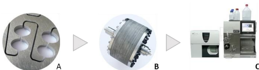
Figure 23: Structure interne formée de canaux et de cellules (A) formant la colonne (B) par jonction des disques entre eux usités. La colonne fait partie d'un module du système CPC (Armen Instruments) (3).
