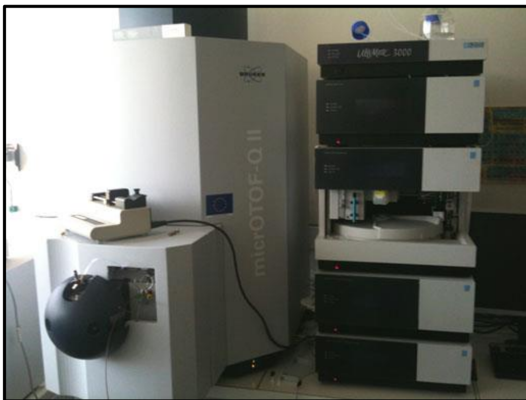
Photo 7 : Photo du système de Chromatographie Liquide Haute Performance couplé à un détecteur de Spectrométrie de Masse (q-TOF).
