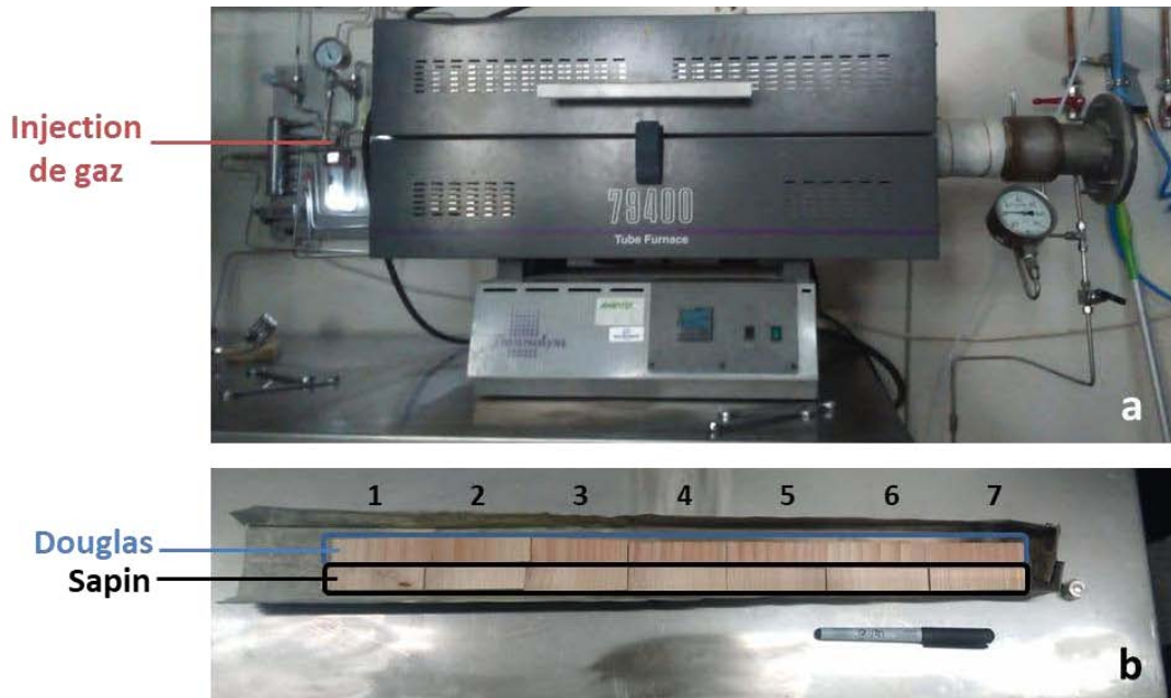
Figure III-16 : Dispositif utilisé lors de la fluoration à l'échelle supérieure (a) et disposition des échantillons avant leur fluoration (b)
