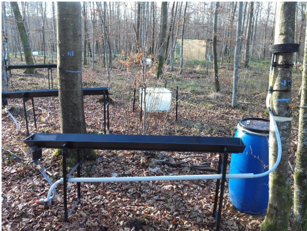
Photographie 4 – Dispositif de récolte des solutions hors sol (gouttière de pluiolessivât, collier d'écoulement de tronc) et des litières (bac à litière) sous le couvert végétal dans la station S3.
