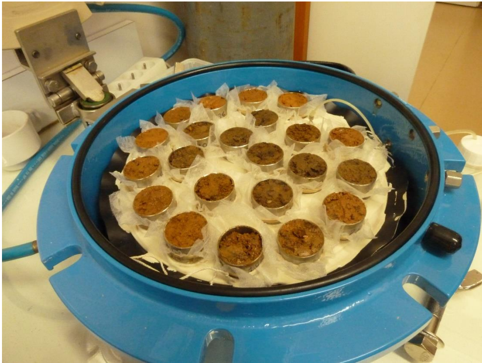
Figure 17 – Echantillons de terre dans la presse de Richards (laboratoire INRA-BEF) utilisée pour l'application de pressions spécifiques en vue de l'établissement des courbes de rétention.
