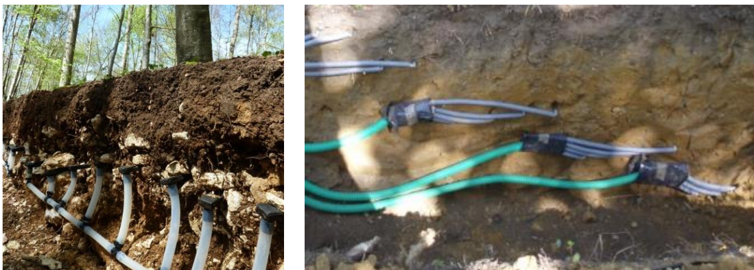
Photographie 17 – Installation de flûteaux (lysimètres sans tension ; à gauche) et de bougies poreuses (lysimètres avec tension appliquée ; à droite) à différentes profondeurs de sol dans une sous-station du site expérimental de Montiers.
