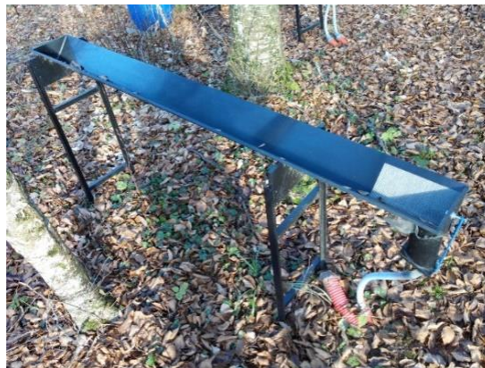
Photographie 6 – Gouttière de prélèvement des pluviolessivats dans le site expérimental de Montiers.
