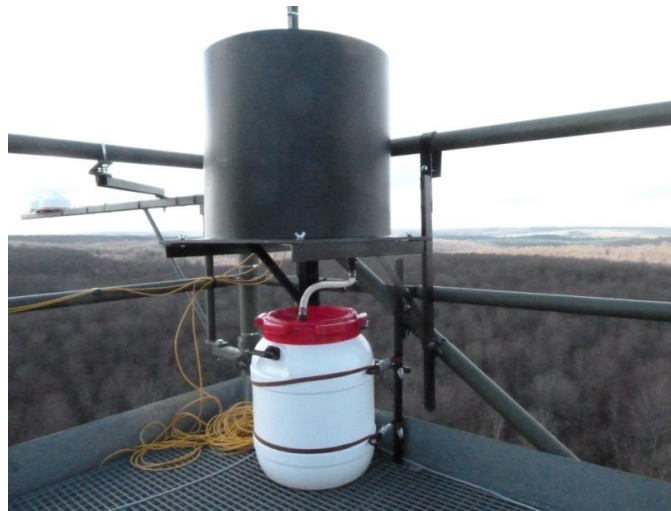
Photographie 5 – Capteur et bidon de collecte des dépôts atmosphériques sur la tour à flux de Montiers.
