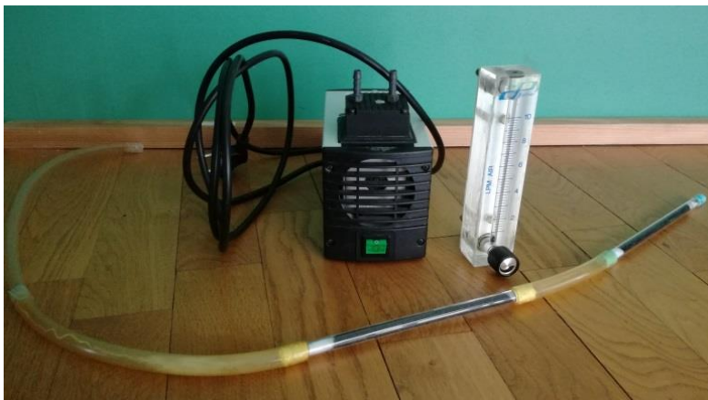
Figure 59 : Dispositif de pompage à travers des filtres à charbon actif pour la détection du Hg atmosphérique.
