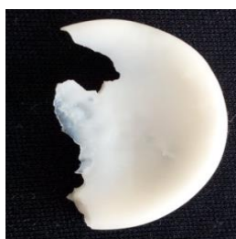
Photographie 1 : Matériau de type Si 9 propyle PU synthétisé à partir du précurseur PDMS 9 propyle OH dépourvu de composés volatils
