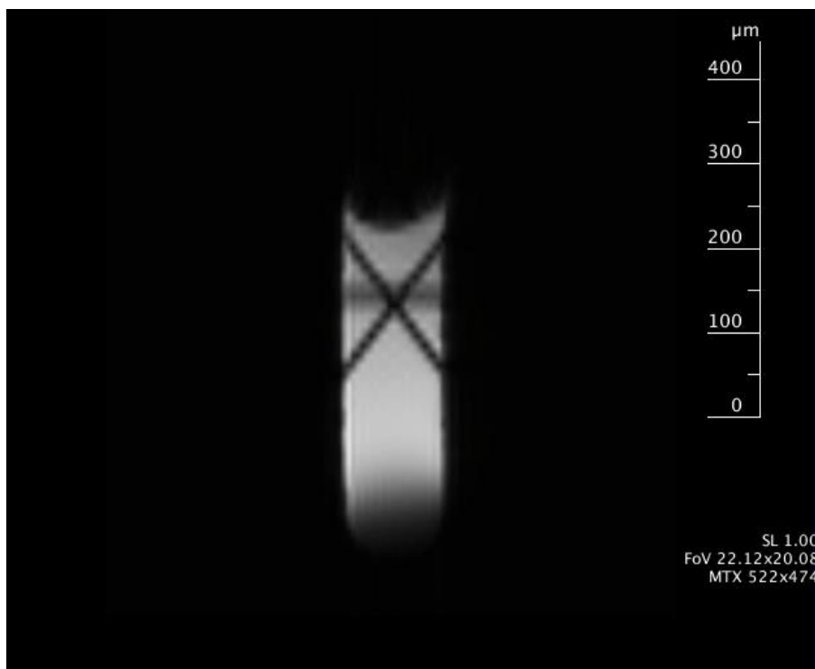
Figure 66 : Image 3D d'un rotor statique rempli d'eau positionné selon l'axe MAS, avec une rotation des gradients permettant d'aligner l'axe MAS avec la dimension verticale de l'image. Une sélection de tranche sans décalage de fréquence a été effectuée dans chacune des directions du repère des gradients. Les trois tranches se croisent au centre du rotor ce qui est caractéristique d'un bon alignement entre les gradients et l'axe MAS, au moins en condition statique.
