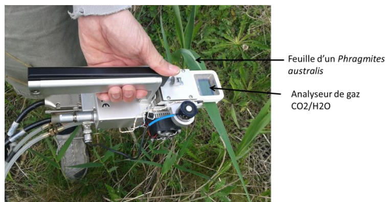
FIGURE 59: PRINCIPE DE L'ÉVALUATION DU TAUX D'ÉVAPOTRANSPIRATION DES ROSEAUX DU FILTRE PLANTE AVEC UN ANALYSEUR DE GAZ
