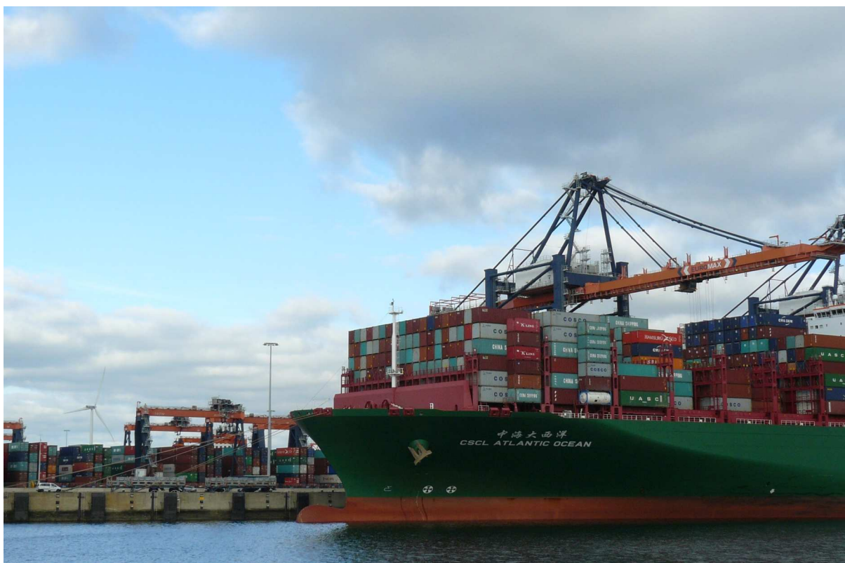
Fig. 17 : Un porte-conteneurs géant d’une compagnie chinoise est déchargé par des portiques semi-automatisés sur le site Maasvlakte II, à Rotterdam – Photo © P. Gras
