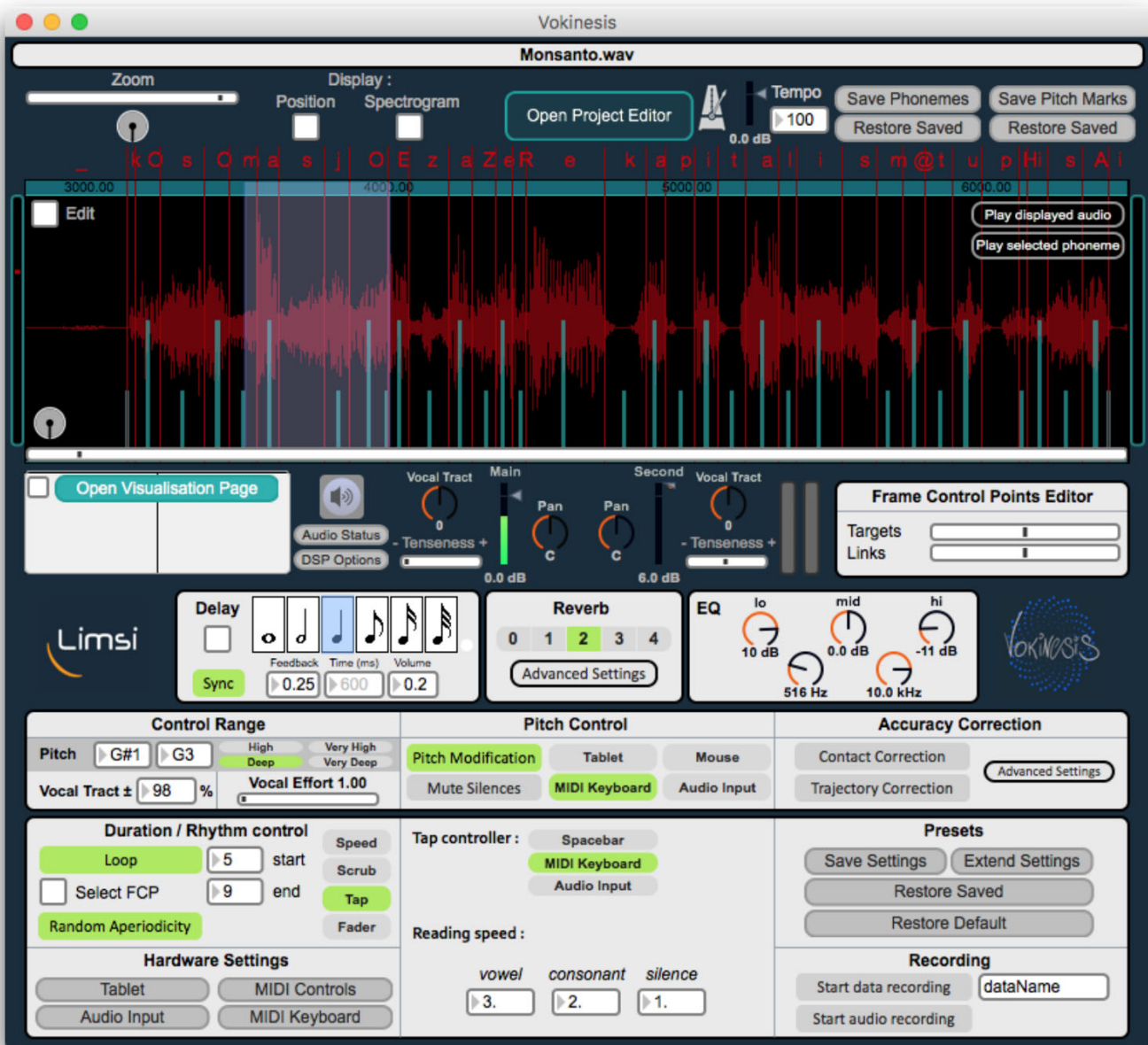
FIGURE 6.3 – Configuration de Vokinesis pour les exemples sonores electro[...]. Pour l'exemple electroVibra, les FCP start et end du cadre Duration / Rhythm Control ont été réglés à 4 et 8.
