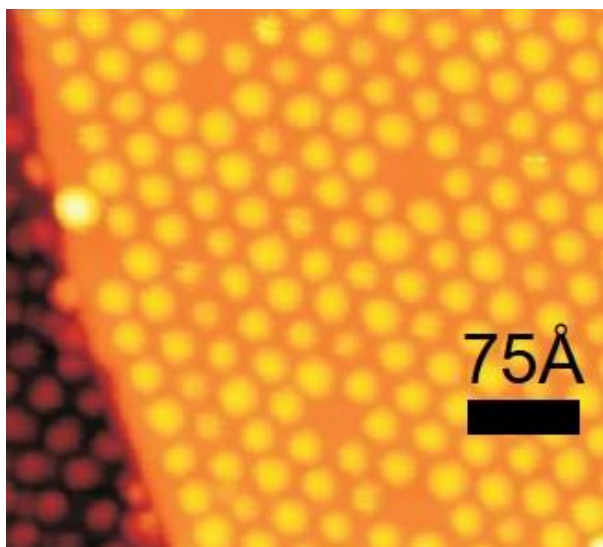
Figure 1-2 : Image STM d'un dépôt de 0.10 ML de NP de Pt déposés sur Gr/Ir(111) à 300 K [43].
