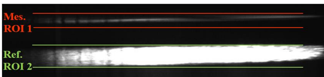
Figure 2-19: Acquisition en mode « full chip » de deux signaux SFG obtenus sur GaAs. Les lignes rouges et vertes mettent en évidence les ROI choisies pour permettre une détection séparée des signaux Mes et Ref sur la caméra.
