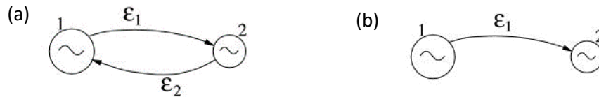
Figure 1.15. Configurations de synchronisation. (a) Synchronisation mutuelle. Les oscillateurs N°1 et N°2 s'influencent mutuellement. (b) Synchronisation unidirectionnelle. L'oscillateur N°1 contrôle l'oscillateur N°2.
