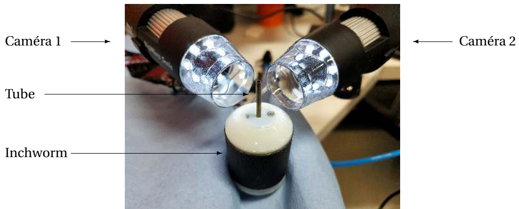
FIGURE 5.22 – Dispositif expérimental utilisé pour la mesure des mouvements transverses du tube durant son déploiement.
