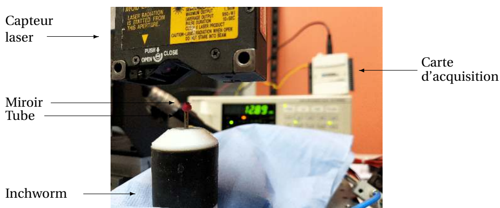
FIGURE 5.25 – Illustration du dispositif expérimental mis en place pour la mesure du pas d'avance fin requis pour le balayage de l'EO.
