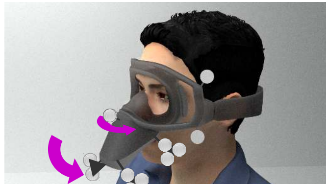
FIGURE 1.16 – Correction de la pose du RTC.
