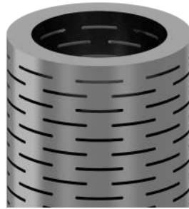
FIGURE 3.11 – Illustration de la forme de motif utilisée pour la structuration des tubes d’un RTC.
