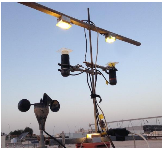
Figure 1. Un microscope d'analyse de salissures pour l'extérieur (OSM) a été développé pour (i) mesurer le dépôt et le détachement des poussières dans de courts intervalles de temps, et (ii) étudier la formation et la croissance de la condensation dans les conditions ambiantes.
