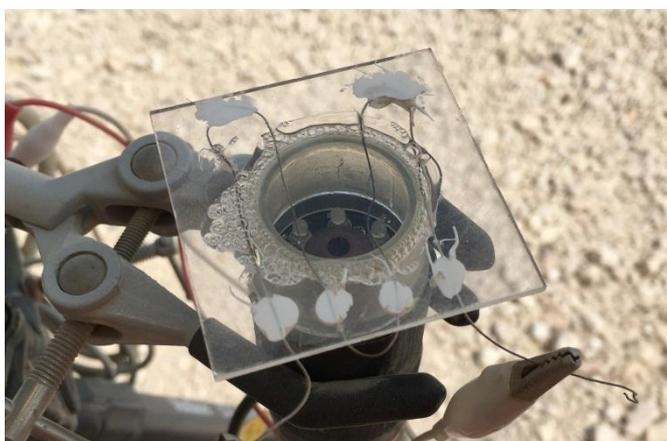
**Figure 15.** Un coupon OSM chauffé a été fabriqué pour isoler l'effet de l'humidité de surface sur les taux de flux de poussière, sur le terrain.
