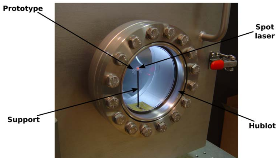
FIGURE 5.3 – Photographie d'un prototype placé dans la chambre à vide employée pour quantifier l'influence de la pression environnante sur son comportement dynamique.
