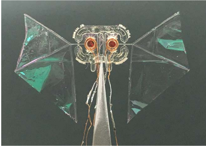
FIGURE P.1 – Photographie d'un prototype de type "Nite Owl" aux ailes découplées avec deux actionneur électromagnétiques.
