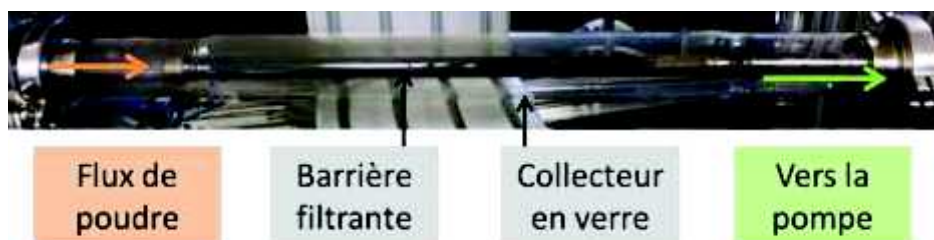
Figure II. 6 : Photographie d'une barrière filtrante avec son collecteur en verre.
