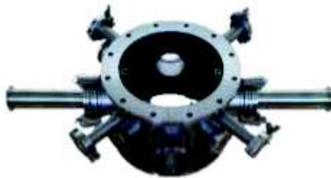
Figure II. 4 : Réacteur de synthèse de pyrolyse laser.
