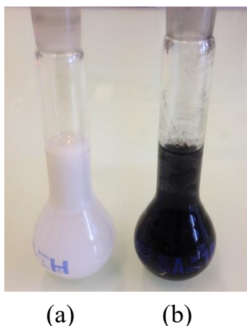
Figure III.1320 : photographie de fioles contenant une suspension de zéolite DaY (a) et de microsphères de carbone W5 (b).
