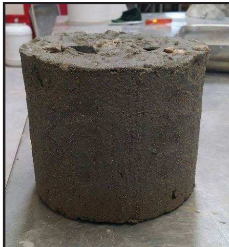
Figure 2- 34 : échantillon de béton à l'issue d'un essai de mesure de perméabilité au perméamètre à charge fixe
