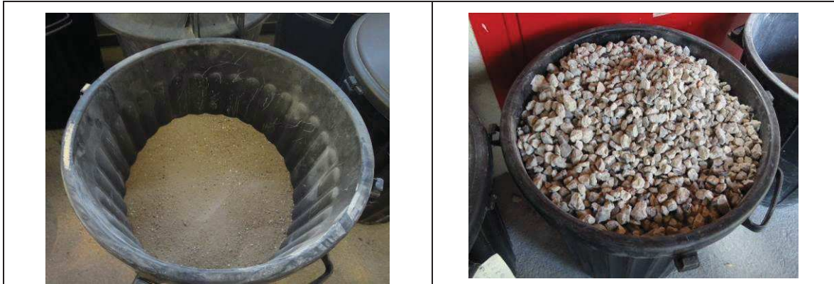
Figure 2- 2 : mode de conservation des granulats à l'état sec en poubelles hermétiquement fermées (sable naturel et graviers recyclés 10 / 20)
