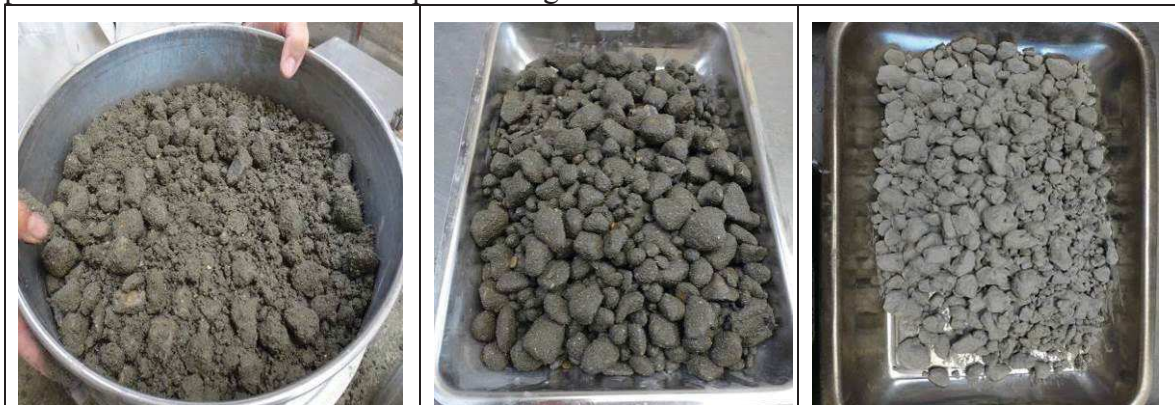
Figure 2- 30 : tamisage d'un échantillon à l'état initial (à gauche), obtention des granulats à mettre à l'étuve à l'état humide (au milieu) puis récupération des granulats secs après étuvage (à droite).
