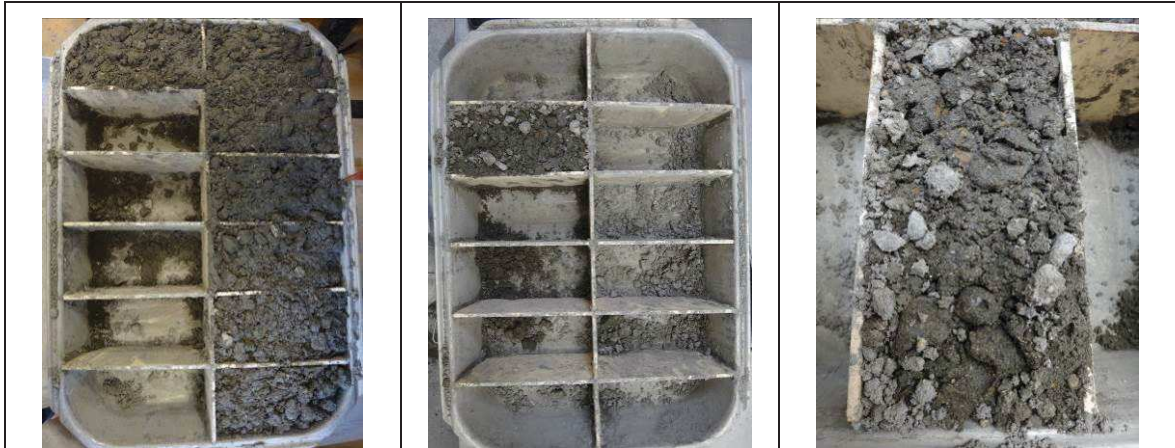
Figure 2- 29 : moule spécialement réalisé pour être placé dans le tunnel ventilé
