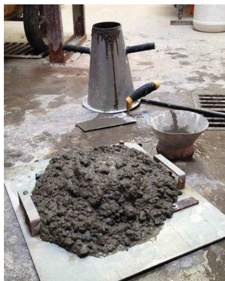
Figure 2- 1 : photographie d'un affaissement de 20 mesuré à l'aide d'un essai au cône
