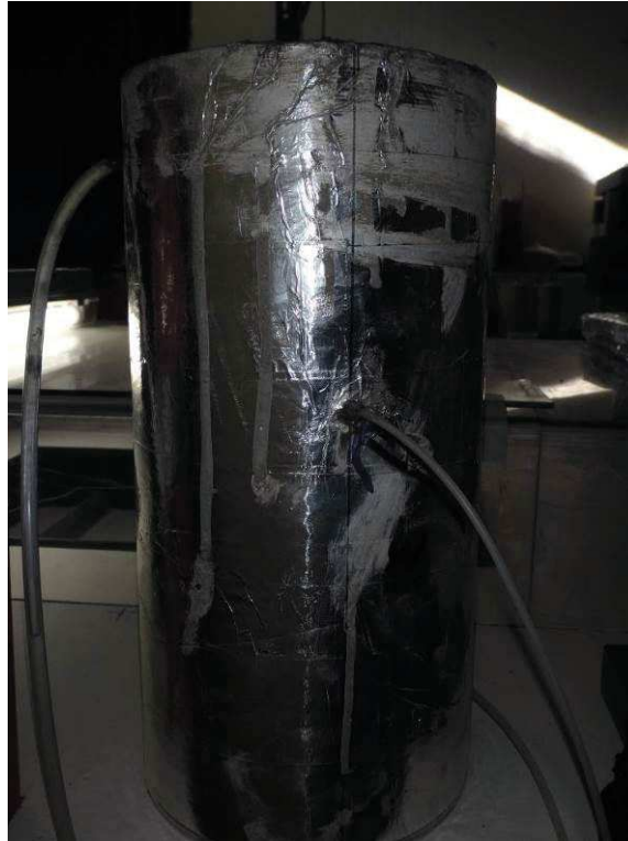
Figure 2- 22 : vue générale d'une éprouvette cylindrique 16 x 32 pour mesure du gradient de pressions capillaires
