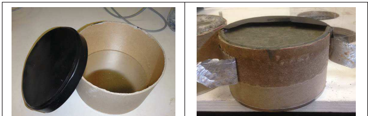
Figure 2- 25 : moules utilisés pour les mesures d'évaporation et conditionnement de l'échantillon endogène
