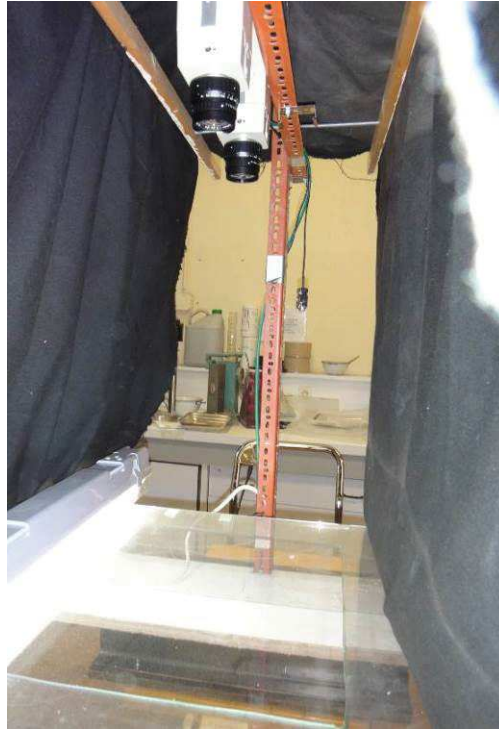
Figure 2- 9 : photo des deux caméras de prise de vues au droit du moule de retrait gêné.
