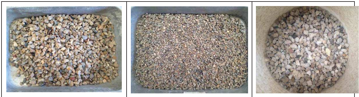
Figure 2- 3 : à gauche gravillons recyclés 10/ 20 pré-saturés en bidon à 1,2A au centre gravillons recyclés 4 / 10 pré-saturés en bidon à 1,2A à droite gravillons recyclés 10 / 20 pré-saturés en bidon à 0,5A
