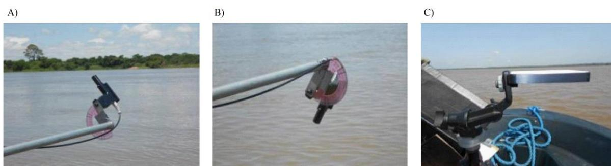
**Figure 3-14.** Mesure de la réflectance in situ sur l'Orénoque avec un spectroradiomètre FieldSpec RS3 modèle 85703 : A) mesure de la radiance du ciel ( $L_d$ ), B) mesure de la radiance de l'eau ( $L_u$ ), C) mesure de l'irradiance ( $E_d$ ) via un panneau portable blanc (Spectralon) en polytétrafluoroéthylène.
