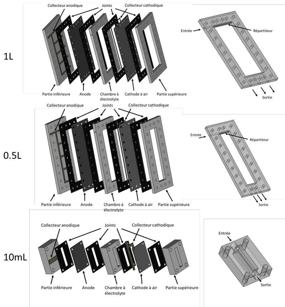
Figure 2. Réacteurs utilisés.
