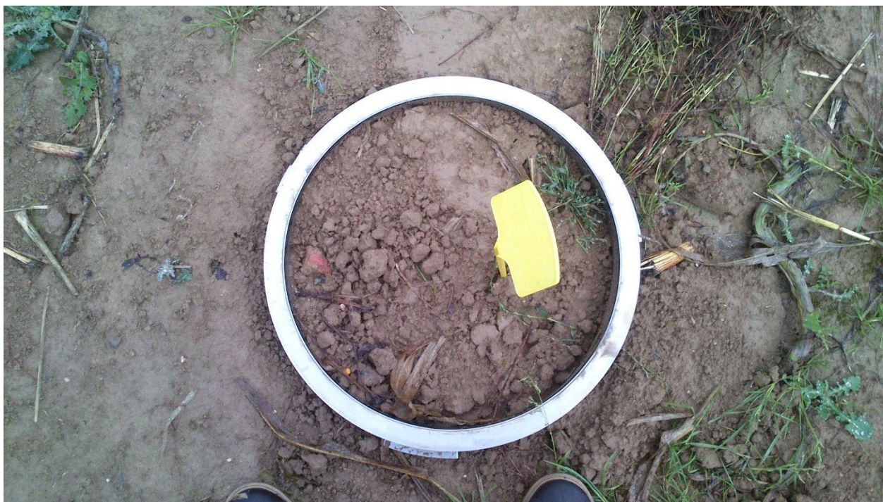
FIGURE 2.5 – Une embase venant d'être mise dans le sol.
