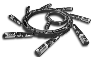
Synchrotron (SOLEIL) 200m de diamètre
