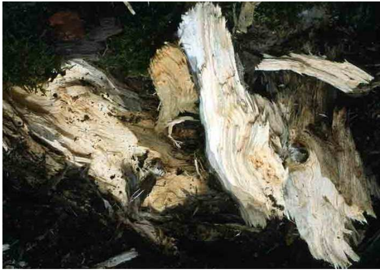
Figure 16 : Image représentant l'action caractéristique des pourritures blanches sur le bois.
