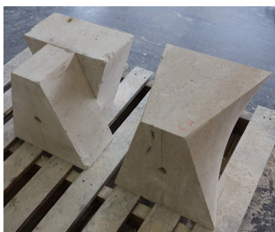
Fig 7.12 – Claveaux – joints en X (IA01 à g.) et joints en X réglés (IA02 à d.)
