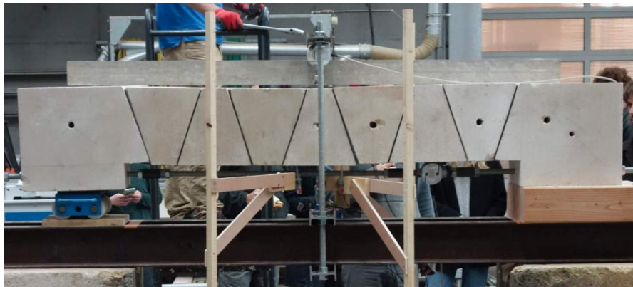
Fig 7.16 – Plate-bande IA02 chargée, avec une règle droite posée sur l'extrados pour visualiser la déformation
