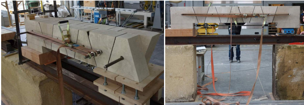
Fig 7.15 – Plate-bande IA01 en cours de montage
