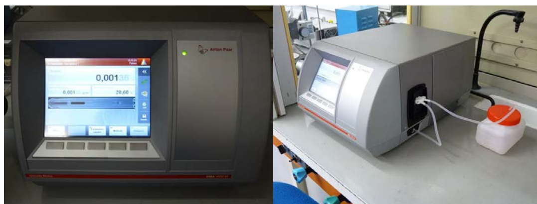
Figure 2.4 – Densimètre vu de face (gauche) et système d'injection et d'évacuation (droite)
