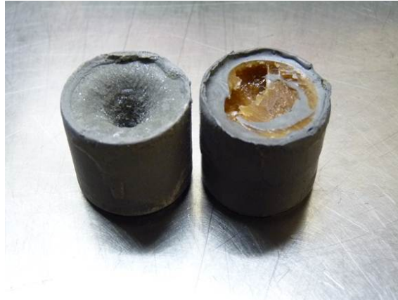
Figure 2.30 – Comprimé nominal avec cire1 (à gauche) et comprimé avec déphasage en cire2 (à droite)
