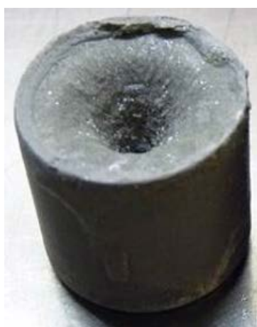
Figure 2.18 – Image d'un comprimé d'ONTA obtenu après des essais au rhéomètre
