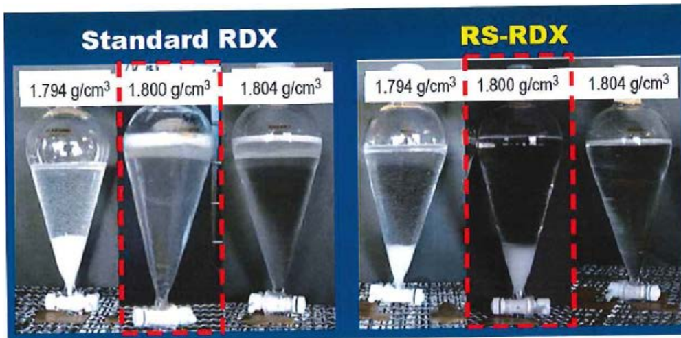
Figure 1.7 – Méthode de flottation de l'ISL appliquée à du RDX et du RS-RDX
