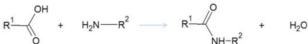
Figure IV.9 Réaction de formation d'un amide à partir d'un acide carboxylique et d'une amine primaire.
