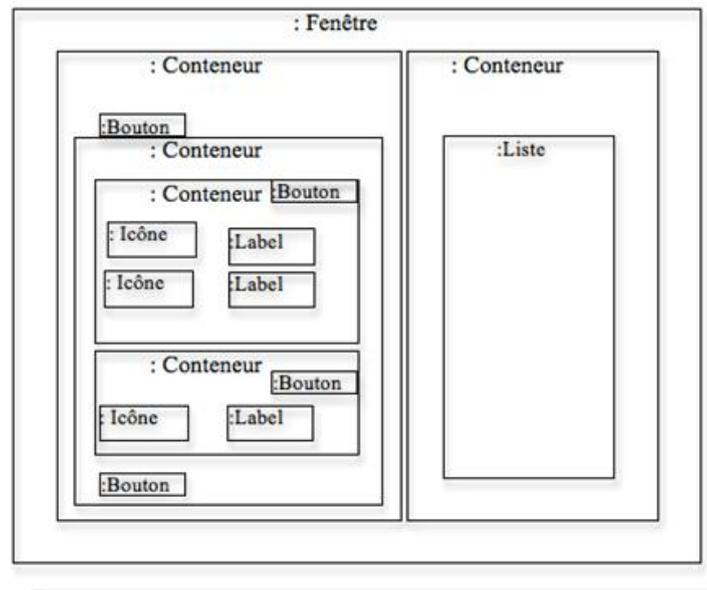
FIGURE 3.19 – Modèle des interacteurs pour la création d'un jeu de facettes et la recherche d'un document
