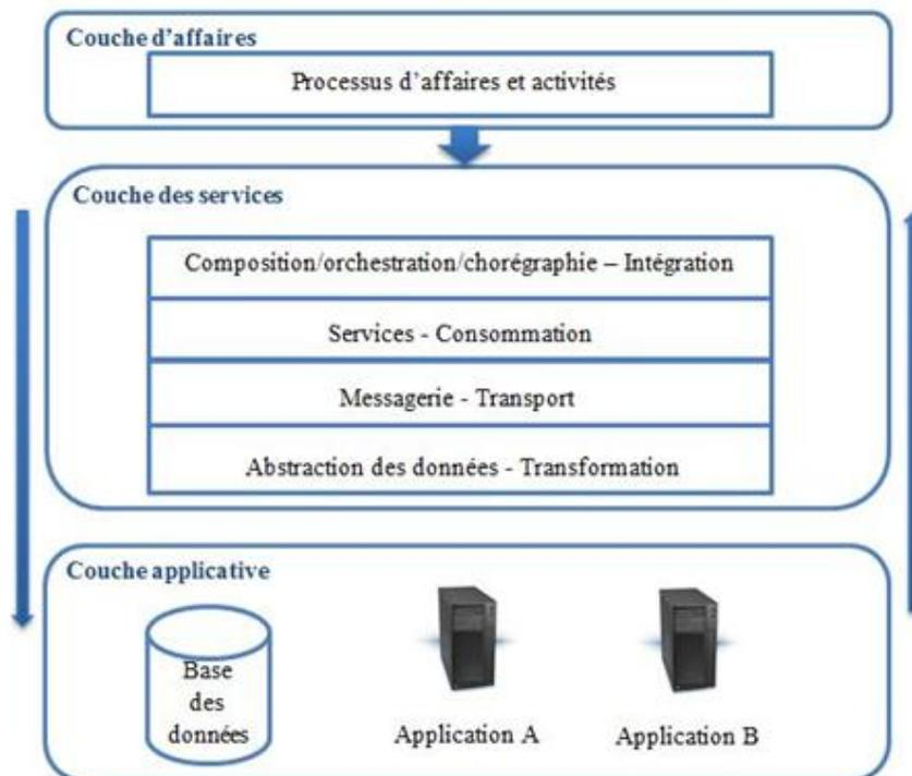
FIGURE 3.27 – Les couches d'une architecture SOA
