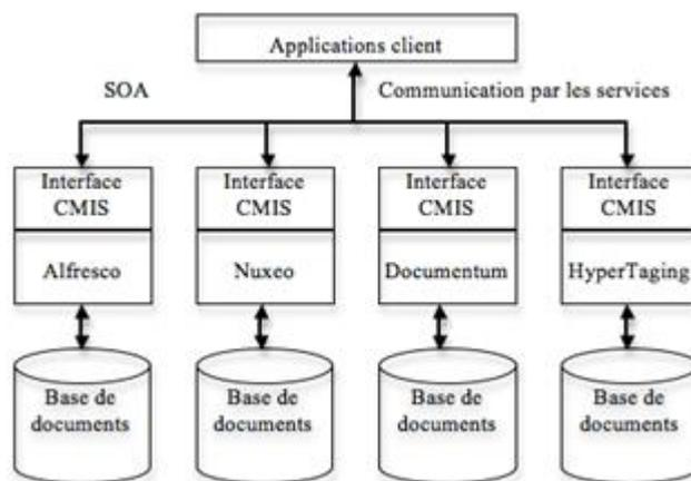
FIGURE 3.47 – Interopérabilité entre différents services utilisant CMIS
