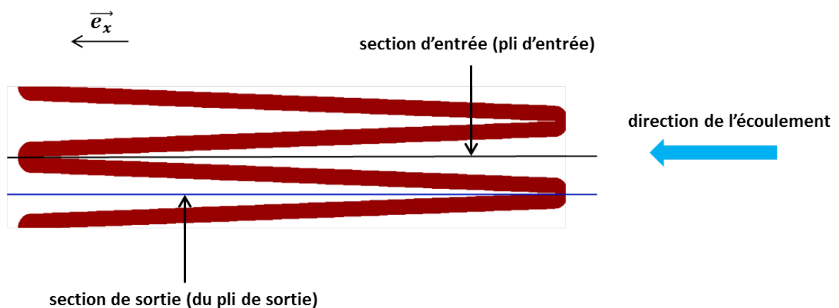
Figure 56 : Schéma explicatif des plis d'entrée et de sortie par rapport à la direction de l'écoulement
