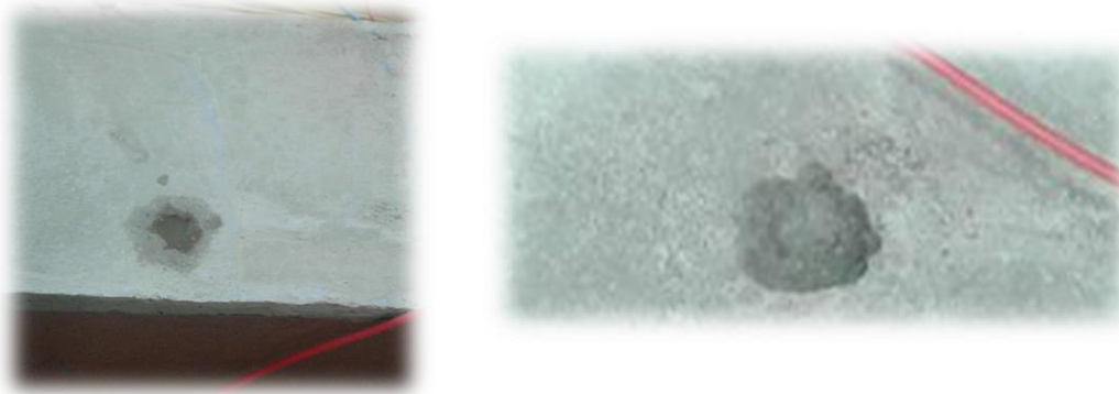
a) Trou rempli d'une solution NaCl
