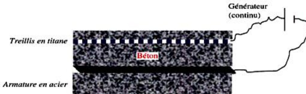
Fig.I. 25- Protection cathodique par courant imposé [6]
