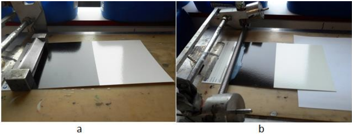
Fig.II. 2- Application par : a-applicateur Bird b-barreau métallique
