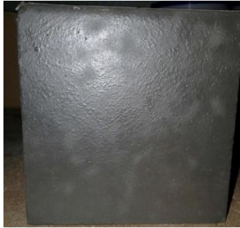
Fig.IV. 18- Témoin T_{Ni2} : observation après 16 semaines
